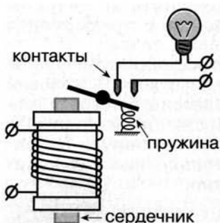
Рис. 2.14 Схема электромагнитного реле
